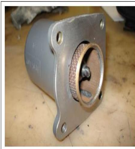
Figure 44 : le carter et son filtre démonté
