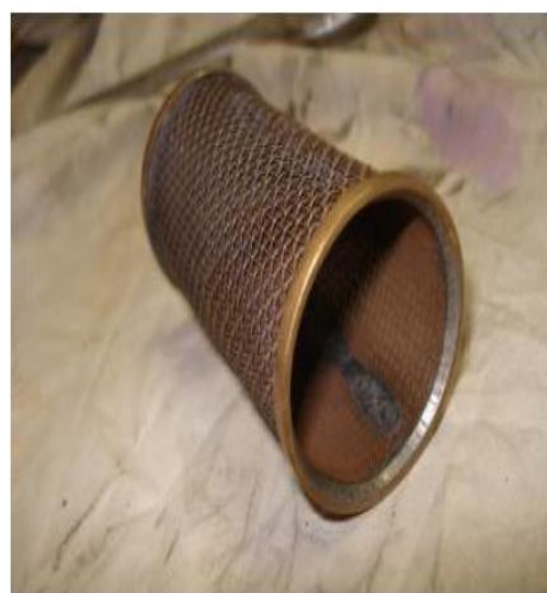
Figure 44 : le carter et son filtre démonté
