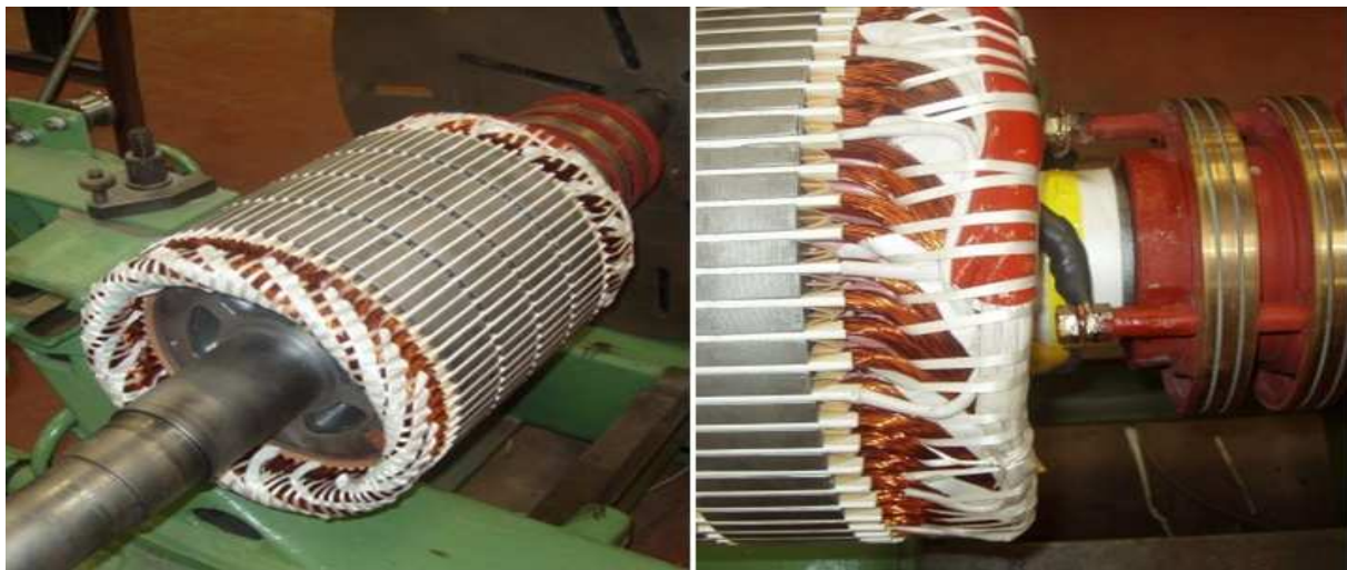
Figure 9 : Rotor bobiné d'une machine asynchrone.
