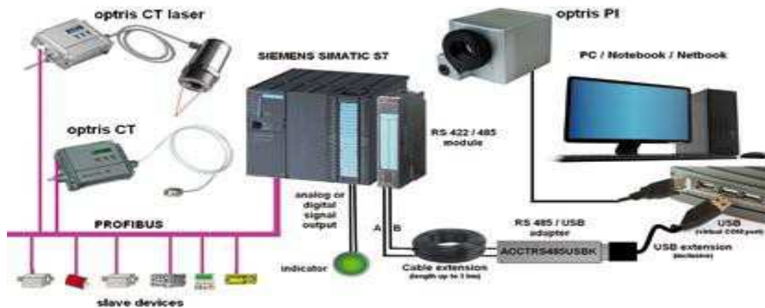
Figure 5. Automate programmable associé avec ordinateur.
